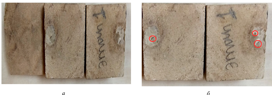
Рис. 4. Образец № 2 (а) и его фрагмент № 2.3 (б). Во фрагменте отчетливо проявляются пустоты (выделены красным) диаметром 2–3 мм (цвет онлайн)
