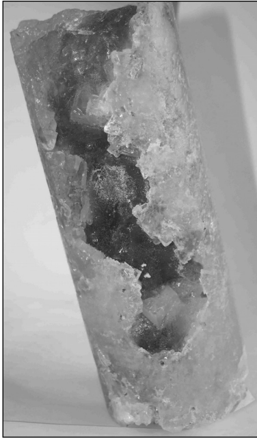
Рис. 6. Керн с жилоподобным телом карналлитового состава в галите (восточный фланг Гремячинского месторождения)
