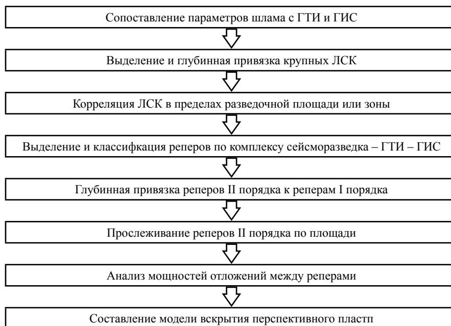
Рис. 2. Технологическая схема составления модели вскрытия перспективного пласта
